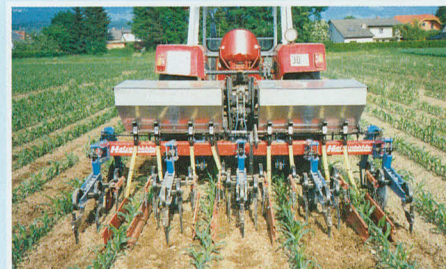
Majsrækkerenser 4-rækket med gødningsspreder og plantebeskyttelsesplader.
