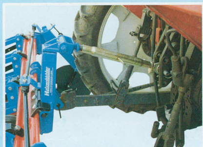
Hatzenbichler 4-rækket majsrækkerenser med automatisk styring, gødningsspreder og plantebeskyttelsesplader
